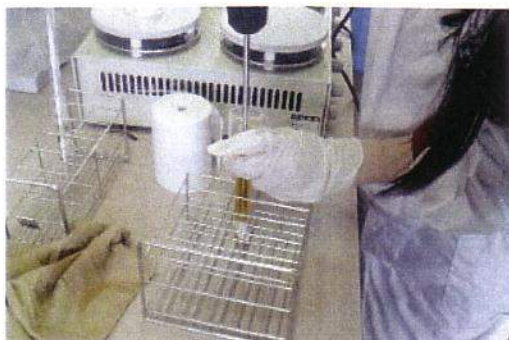
図1 テフロン製ホモジナイザーによるリコピンの抽出の様子
